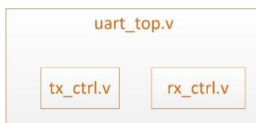
图 7.2-2 串口模块框图
