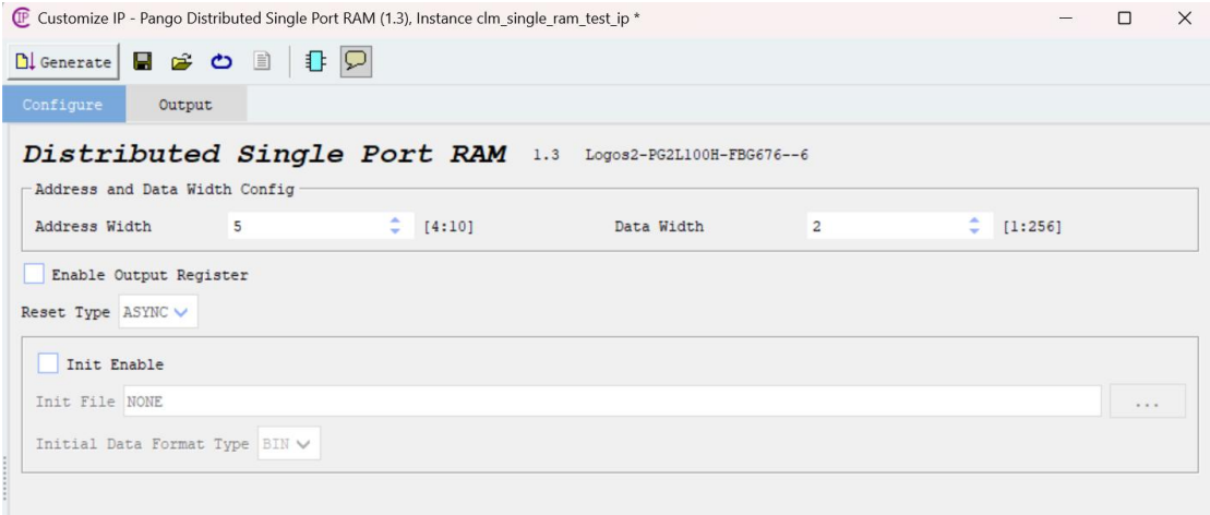
图 2.1-3 测试实验设置的 IP 核参数
