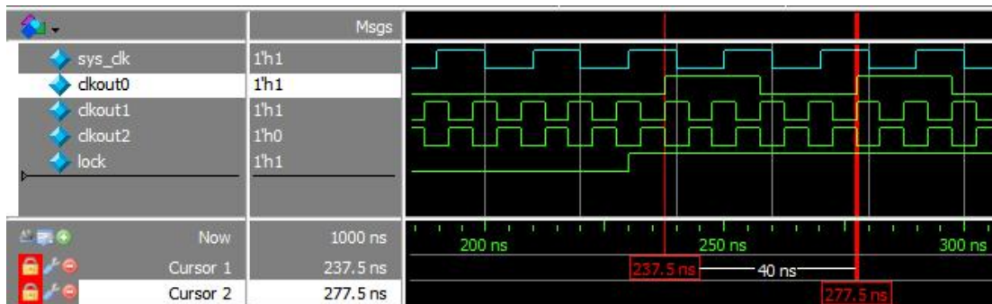
图 3-11.5- 1 PLL IP 使用实验结果波形图 1
