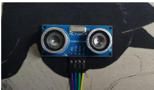
图 3-16.2-1 超声波测距模块图
