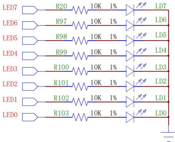
控制 LED 依次 0.5s 亮, 0.5s 灭, 需要控制 IO 依次输出 0.5s 高电平, 0.5s 低电平周期变化, 如下图波形:
