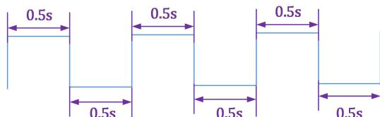
使用 50MHz 外部输入时钟, 时钟周期为 20ns (在 verilog 设计中的计数器的计时原理基本上是一致的, 确认输入时钟周期和目标计时时间后可得到计数器的计数值到达多少后可得到计时宽度) ;
