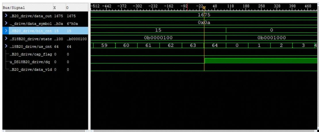
由上图可知在发送完成 16bit 命令 [CCh] [44h] 之后状态机跳转到等待状态，等待 DS18B20 进行温度转换，共等待 750ms，此时总线拉高。由此可见状态跳转逻辑正确。接下来就是再次进行初始化，发送命令 [CCh] [BEh]，状态机跳转到接收温度数据状态，开始读数据。我们将触发模式设置为 ( $state = 7'$   $b1000\_000 \&& bit\_cnt = 15 \&& us\_cnt = 64$ ) (状态机接收温度数据，并且接收完成)，捕获到的波形图如下：
