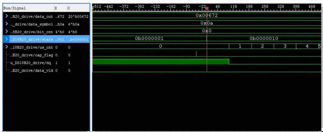
然后设置触发模式为 ( $state = 7 \wedge b0000\_010 \wedge \& us\_cnt = 959$ ) （状态机处于 DS18B20 初始化状态，接收到应答完成），DS18B20 总线复位时序中我们有说明，一整个复位操作包括主机发送复位与从机应答总共 960us，我们以此作为条件观察复位是否成功，按下按键观察捕获到的波形如下：
