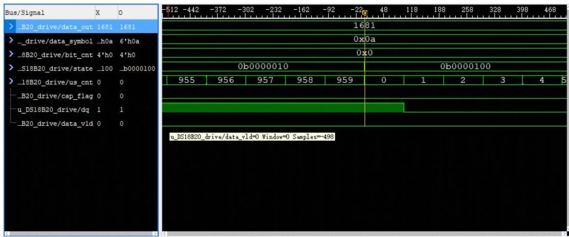
由上图可知当  $us\_cnt = 959$  时，状态机跳转到下一状态，同时总线拉低，符合我们的复位时序。
