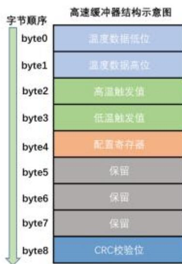
DS18B20 的高速缓冲器是一个临时存储温度测量数据和配置参数的小型存储器，用于在温度转换和数据通信过程中缓存必要的信息。由上图可知缓冲器由 9 个字节组成，其中包括测量的温度数据（前两个字节）、配置寄存器（第四个字节）、以及内部保留位等。用户可通过配置寄存器设置分辨率，而其他字节中的特定位被保留用于内部用途，不可写入。在配置寄存器的 8 个比特位中，只有第 5 位 (R0) 与第 6 位 (R1) 可以由用户配置，其他位都保留给 DS18B20 内部使用。R0 与 R1 的组合决定了传感器的分辨率，以及温度转换所需的时间。它们的作用可以理解为配置选项的二进制编码开关，通过不同的值组合实现分辨率的选择。详情请看下面的图片：
