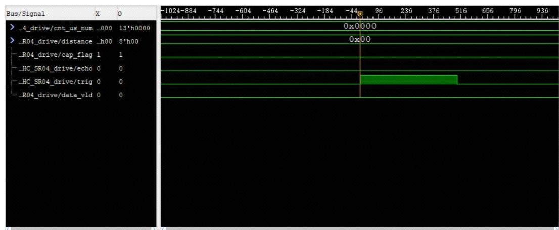
接下来在超声波测距模块 30cm 处放置一物体（需要大一些），将触发模式设置为 data\_vld 信号高电平触发，按下开发板按键 k0，发现计算出的距离值为 30，微秒计数器的值为 1769，符合我们的预期。如下图所示：
