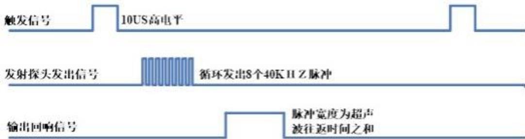
我们使用 PGX-Nano 开发板作为微控制器，首先我们向 HC-SR04 模块的 trig 引脚发送一个持续 10us 的触发信号，HC-SR04 收到我们给出的触发信号之后，会使用超声波探头发射 8 个 40khz 的脉冲。当测距结束后，HC-SR04 会通过 echo 引脚发送一个高电平信号，高电平持续时间就是声波往返物体经历的时间。我们利用这段时间就可以计算出物体到超声波模块的距离。
