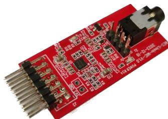
需注意的是，麦克风输入的音频信号一般只有一个声道，此时如果不做任何处理，输出的也将只会有一个声道，考虑到这种情况，音频模块可以使用跳线帽扣在音频输入模块上最左侧的两个跳线针上，在电路上将左声道与右声道连接，此时音频输入模块左右两通道将都有信号输入。
