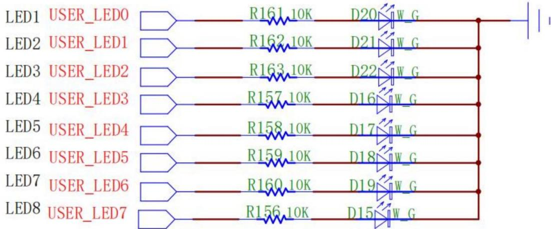
控制 LED 依次 0.5s 亮, 0.5s 灭, 需要控制 IO 依次输出 0.5s 高电平, 0.5s 低电平周期变化, 如下图波形:
