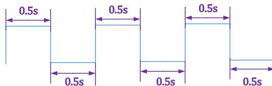
若使用 50MHz 外部输入时钟, 时钟周期为 20ns (在 verilog 设计中的计数器的计时原理基本上是一致的, 确认输入时钟周期和目标计时时间后可得到计数器的计数值到达多少后可得到计时宽度) ;
