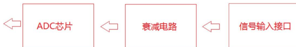
图 8 ADC 转换流程
